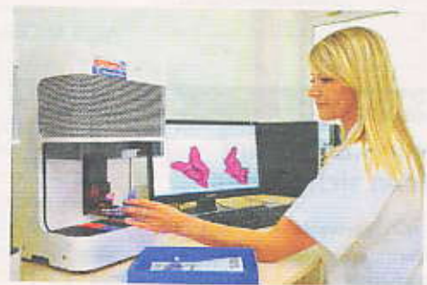
Am 3D-Drucker entsteht ein Modell des Ohres, in dem die Schale angepasst wird
